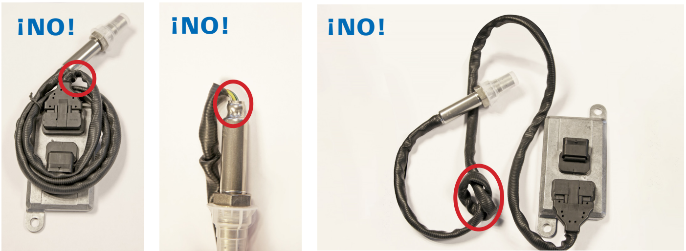
Figura 5. Manejo inadecuado del cable.
